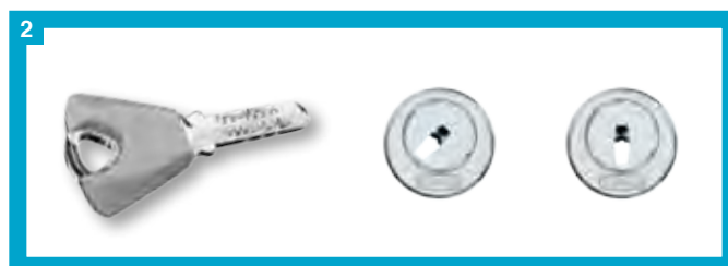
2. La clé de référence pour la variante 2 est enfoncée dans la position à 45° puis tournée vers la gauche pour retrouver la position verticale initiale. Une fois la clé retirée, le cylindre est codé pour la variante 2 et l'accès avec la clé 1 est bloqué.
